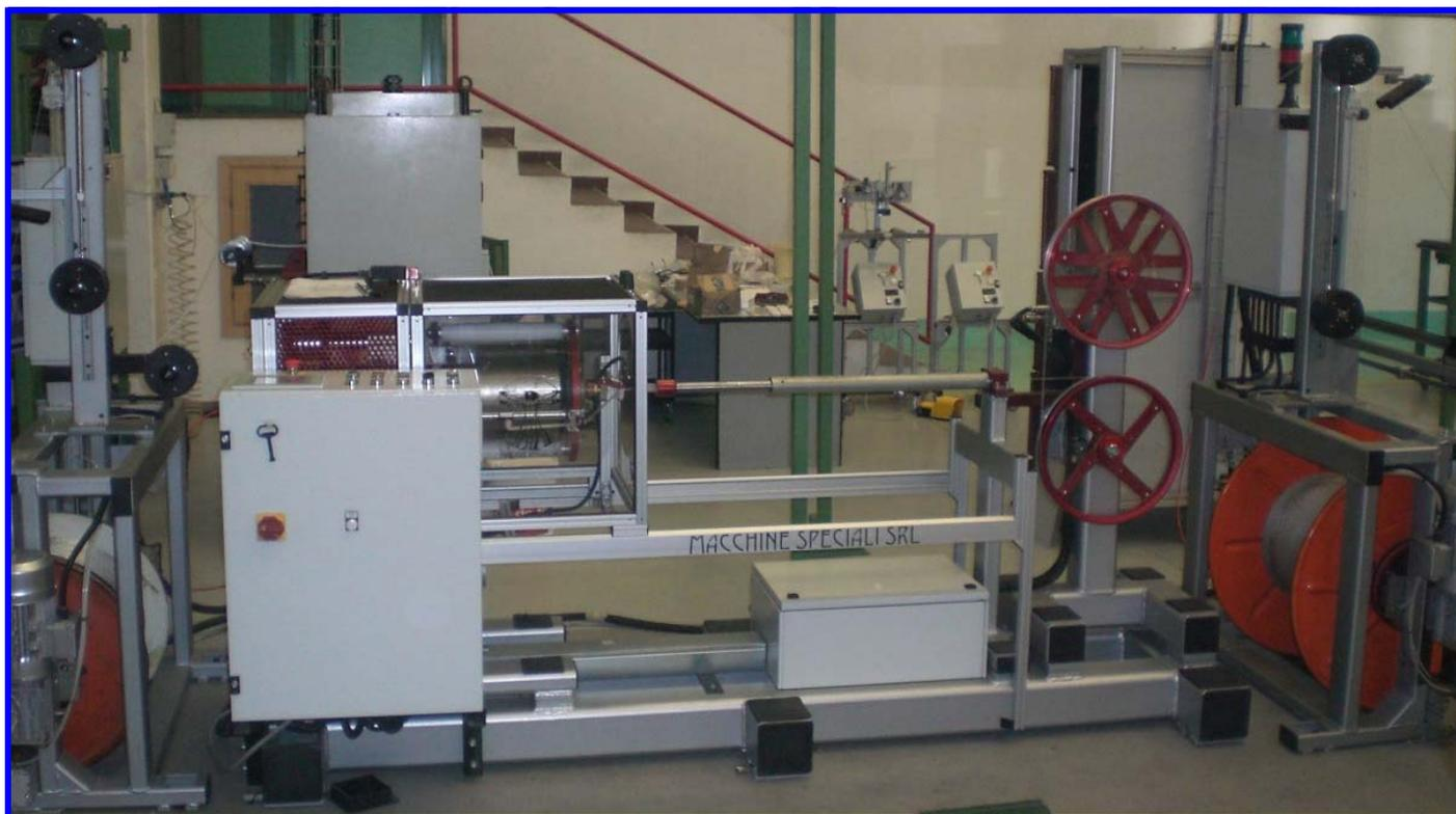
La linea, composta da svolgitori, testa a nastro concentrica, volano e avvolgitore può essere usata per nastrire cavi fino a 10 mm di diametro. Tutta la linea è controllata tramite digital bus per la sincronizzazione di tutti i motori e azionamenti. Tutti i parametri di tiro del nastro potranno essere gestiti con ricette impostabili da touch screen.
